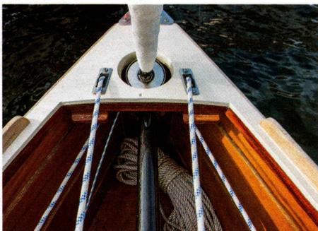
Die Schoten der Selbstwendefock sind doppelt ausgeführt, um immer eine in Luv zu haben
