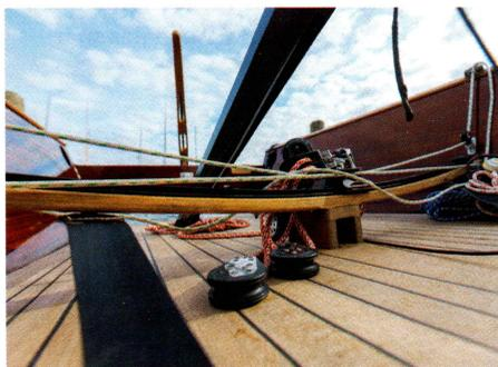
Der Traveller ist auf einem erhöhten Reitbalken montiert, der auch die Ausreitgurte aufnimmt
