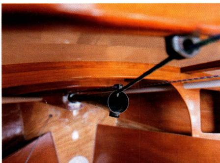
Der Bugspriet fährt per Leinenzug aus. Die Halsleine ist durch das Carbonrohr geführt
