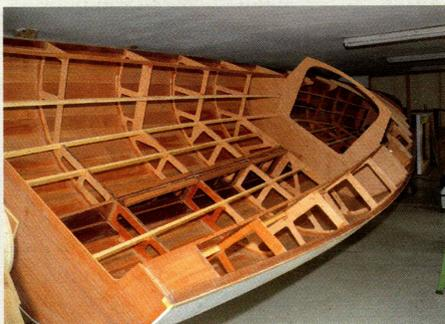
Das filigran aufgebaute Boot wird mit diversen ausgesägten Rahmenspannen versteift
